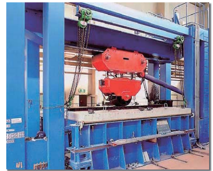
旧建設省土木研究所における輪荷重走行試験
